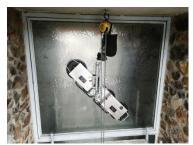
Kappel Sauganlage DSKE2-12V 3 Meter (450 kg) 2-Kreis Vakuumsystem, 4 - 6 Saugteller Tragkraft bis 450 kg, Eigengewicht 60 kg, Tiefe 190 mm Abmessungen min. 330 x 2050 mm - 4 Teller - 300 kg max. 330 x 3050 mm - 6 Teller - 450 kg manuelles Drehen 360°, Kippen 90°, 12 Volt Akku Vermietung nur in Verbindung mit Kran oder Bedienpersonal Euro 230,00 netto/je angefangener Tag
